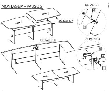
NA SEQUENCIA PARA FACILITAR A FIXAÇÃO DO TAMPO (1), COM A ESTRUTURA EM PÉ, FAÇA O ENCAIXE DO TAMPO (1) NOS PÉS PAINÉIS LATERIAS (3,4) CONFORME INDICA DETALHE 4. APÓS O TAMPO (1) POSICIONADO, FAÇA O TRAVAMENTO COM AS CHAPAS DE CONEXÃO COMO INDICA O DETALHE 5.
